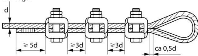
Die Schrauben müssen abwechselnd gleichmäßig angezogen werden. Die Schrauben müssen angezogen werden, wenn das Seil belastet ist.
