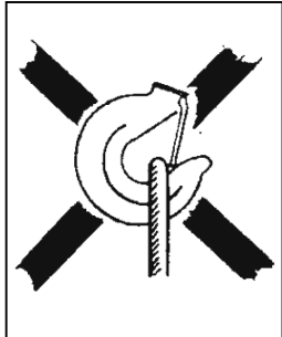
Kuva 4 a Silmukka kuormittaa koukun kärkeä!
