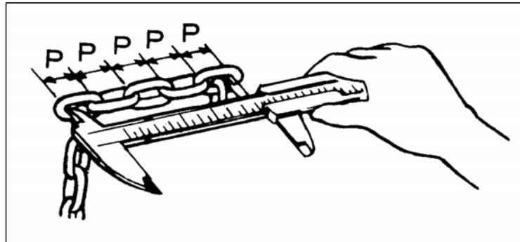
Imag. 7 Comprobar las dimensiones de la cadena
